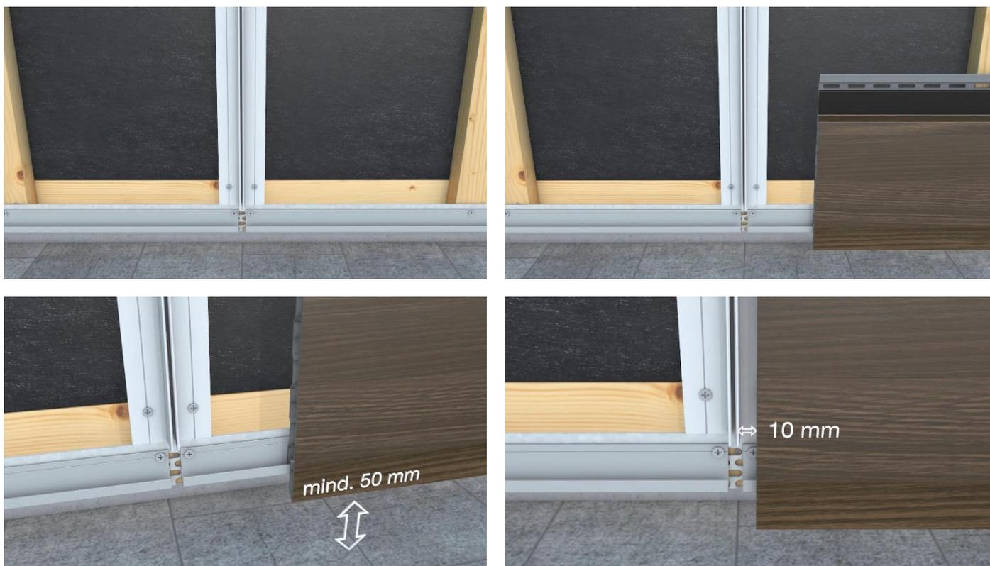
La pose des lames doit se réaliser impérativement en vérifiant le niveau de celle-ci, sur la première lame posée puis toutes les 2 lames supplémentaires.
