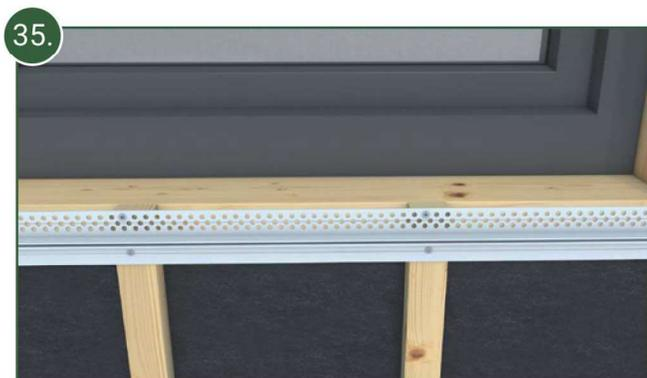
Visser sur la partie inférieure de la tablette de fenêtre une partie inférieure du profil de ventilation afin d'assurer une circulation d'air dans cette zone
