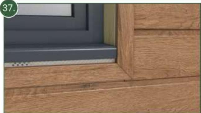
Réaliser les coupes à onglet nécessaire des parties supérieures des profils de ventilation et de finition puis les clipser sur les parties inférieures déjà montées. Veuillez tenir compte pour la longueur des parties supérieures d'une dilatation possible du profilé d'environ 3 mm par mètre.
