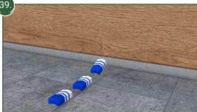
Le principe de la ventilation arrière est maintenant complété par l'entrée d'air en bas de la façade.
