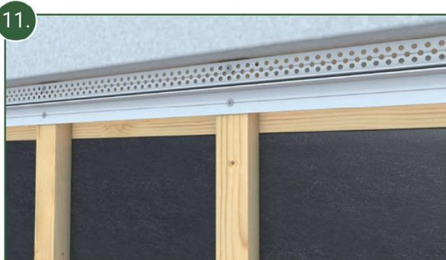
11. Visser, dans la rainure prévue, la partie inférieure du profil de ventilation (BAR\_PV) sur la partie supérieure de la façade selon le schéma.
