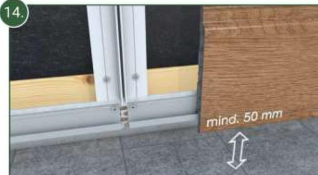
14. Le montage des lames commence par le bas de la façade en plaçant la première lame dans le U de départ en aluminium. Veuillez respecter une distance minimale de 50 mm entre la partie inférieure de la lame et le sol pavé.
