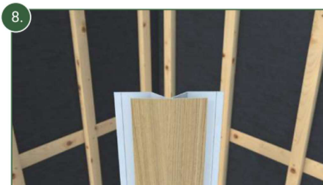
8. Utiliser l'angle intérieur (BAR_AI) dans les angles prévus à cet effet.
