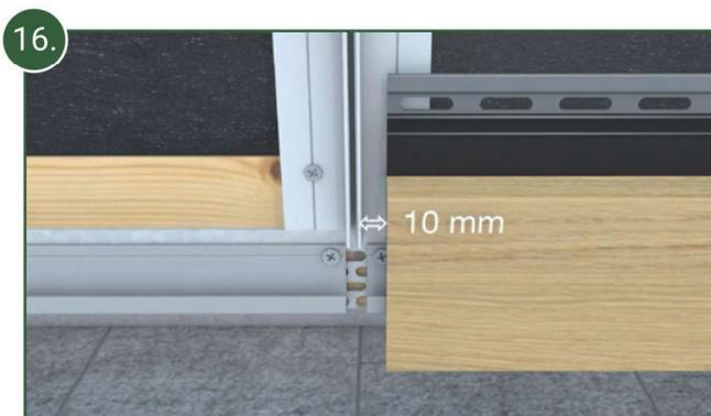
16. La distance de dilatation entre les extrémités des lames et les extrémités des parties inférieures des accessoires doit être de 10 mm de chaque côté.
