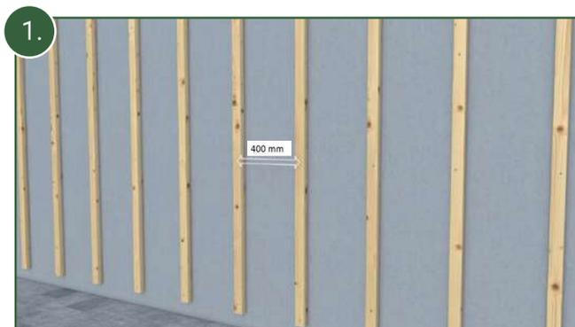
1. Visser les chevrons de 40x40 mm sur le support existant en les espaçant de 400 mm.
