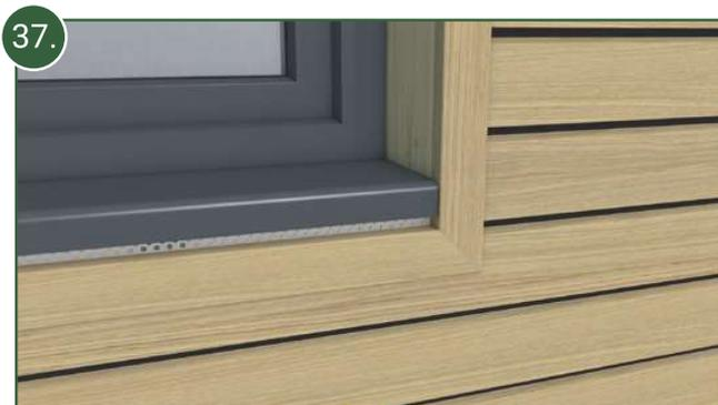
37. Réaliser les coupes à onglet nécessaire des parties supérieures des profils de ventilation et de finition puis les clipser sur les parties inférieures déjà montées. Veuillez tenir compte pour la longueur des parties supérieures d'une dilatation possible du profilé d'environ 3 mm par mètre.
