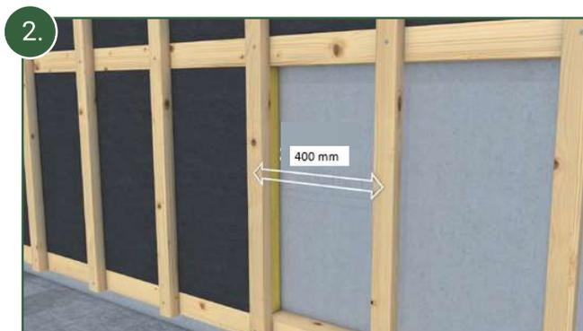
2. En cas de pose sur un matériau de type isolation par l'extérieur, la pose des chevrons s'effectue comme sur la figure 1.
