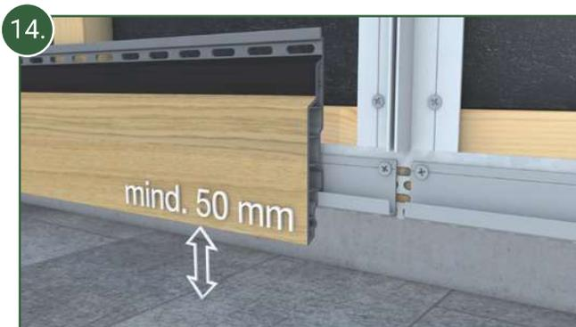
14. Le montage des lames commence par le bas de la façade en plaçant la première lame dans le U de départ en aluminium. Veuillez respecter une distance minimale de 50 mm entre la partie inférieure de la lame et le sol pavé.
