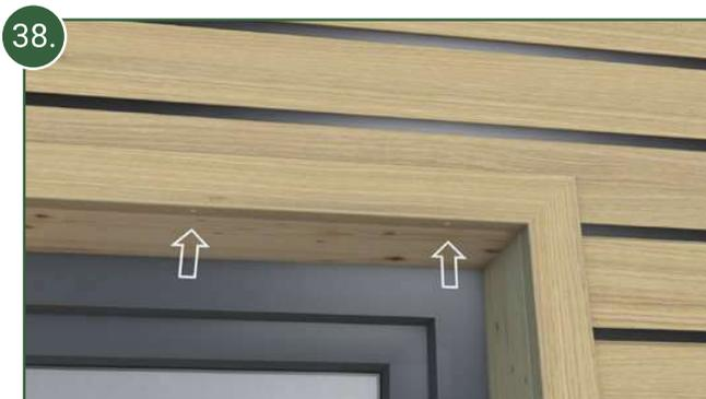
38. Dans la zone située au-dessous de la fenêtre, il faut prévoir tous les 20 cm des trous de drainage de 6 mm de diamètre dans le profilé de finition afin d'assurer l'écoulement des eaux de pluie.
