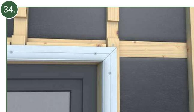
Monter les parties inférieures des profilés de finition à fleur le long de l'embrasure de la fenêtre. Les angles se font par coupe à onglet.
