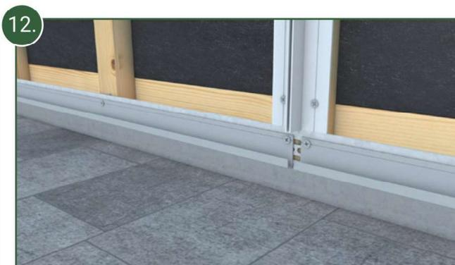
12. Fixer le U de départ en aluminium au même niveau que le bord inférieur de la grille de ventilation (BAR\_GRILLE). Attention : dans la zone des H de dilatation, le U de départ doit être coupé afin de laisser le passage à la partie supérieure du H.
