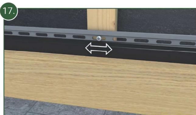
17. Le vissage des lames sur les chevrons se fait avec les vis de fixation (BAR\_VIS). Ces vis doivent être placées au centre des trous oblongs. La lame doit posséder encore du jeu.
