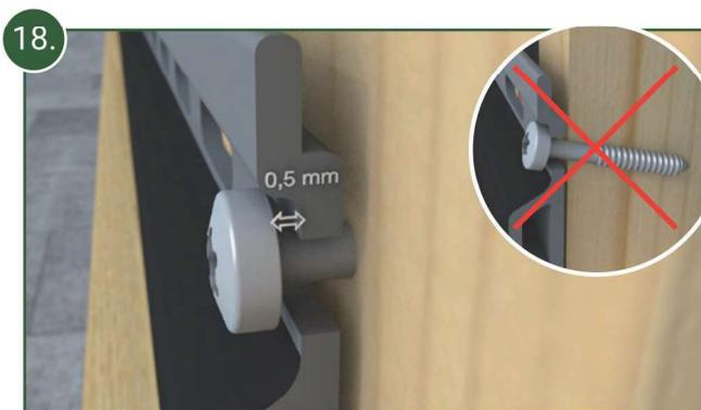
18. ATTENTION : Les vis doivent être serrées de manière à ce que la lame puisse bouger après le vissage. (laisser un espace d'environ 0.5mm) Les vis ne doivent pas être introduites en biais.
