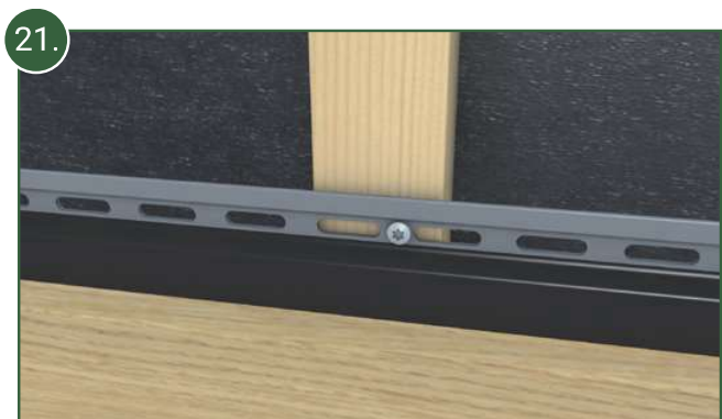
Le point de fixation s'obtient en positionnant une vis entre deux trous oblongs puis en serrant cette dernière à fond.
