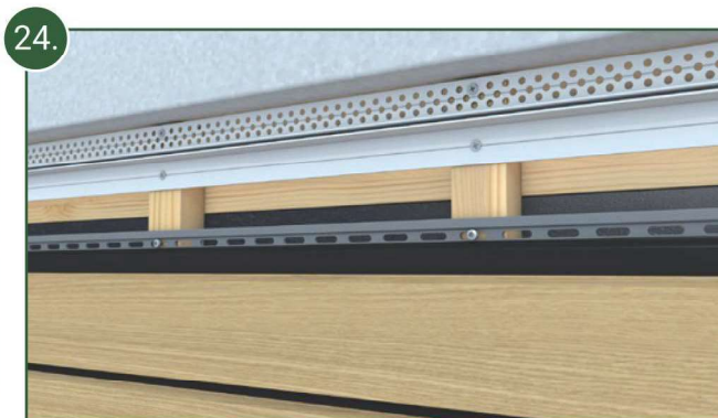
La dernière lame au niveau de la finition supérieure de la façade devra, dans la plupart des cas, être raccourcie dans le sens de la longueur.
