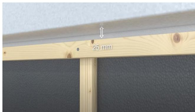
Au droit des ouvrants, il conviendra de raboter les chevrons ou de les démarrer plus haut, pour permettre le passage de l'air et la ventilation à l'arrière des lames.
